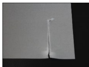
不燃シートの破れ
