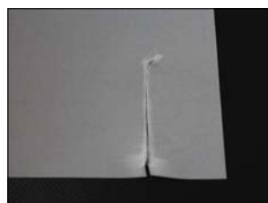
不燃シートの破れ
